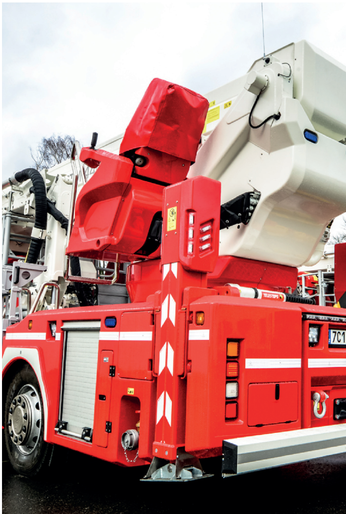
Nr 80. Ukończone stanowisko sterownicze przy kolumnie podnośnika PTM-44D / FM Bumar S.A / w Koszalinie
