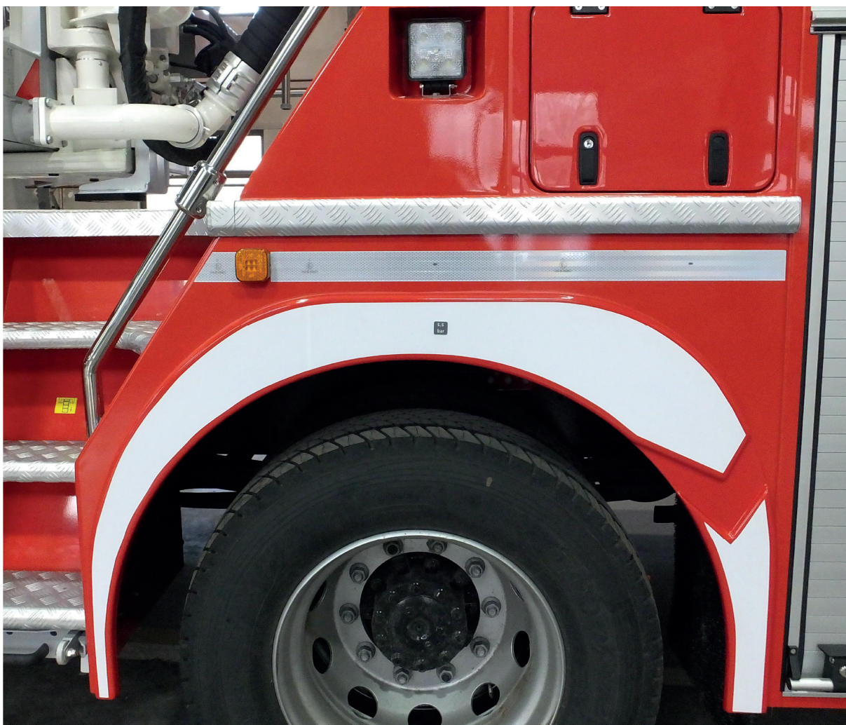
Nr 54. Wydruk 3d modelu nadkola oraz gotowe nadkole wykonane z laminatu i oklejone białą folią dla FM Bumar S.A / w Koszalinie
