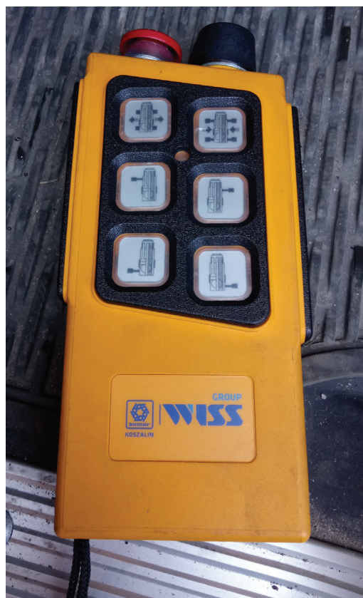
Nr 30 A. Projekt opisu funkcji pilota sterowania radiowego do rozstawiania podpór w podnośniku pożarniczym / FM Bumar S.A / w Koszalinie
