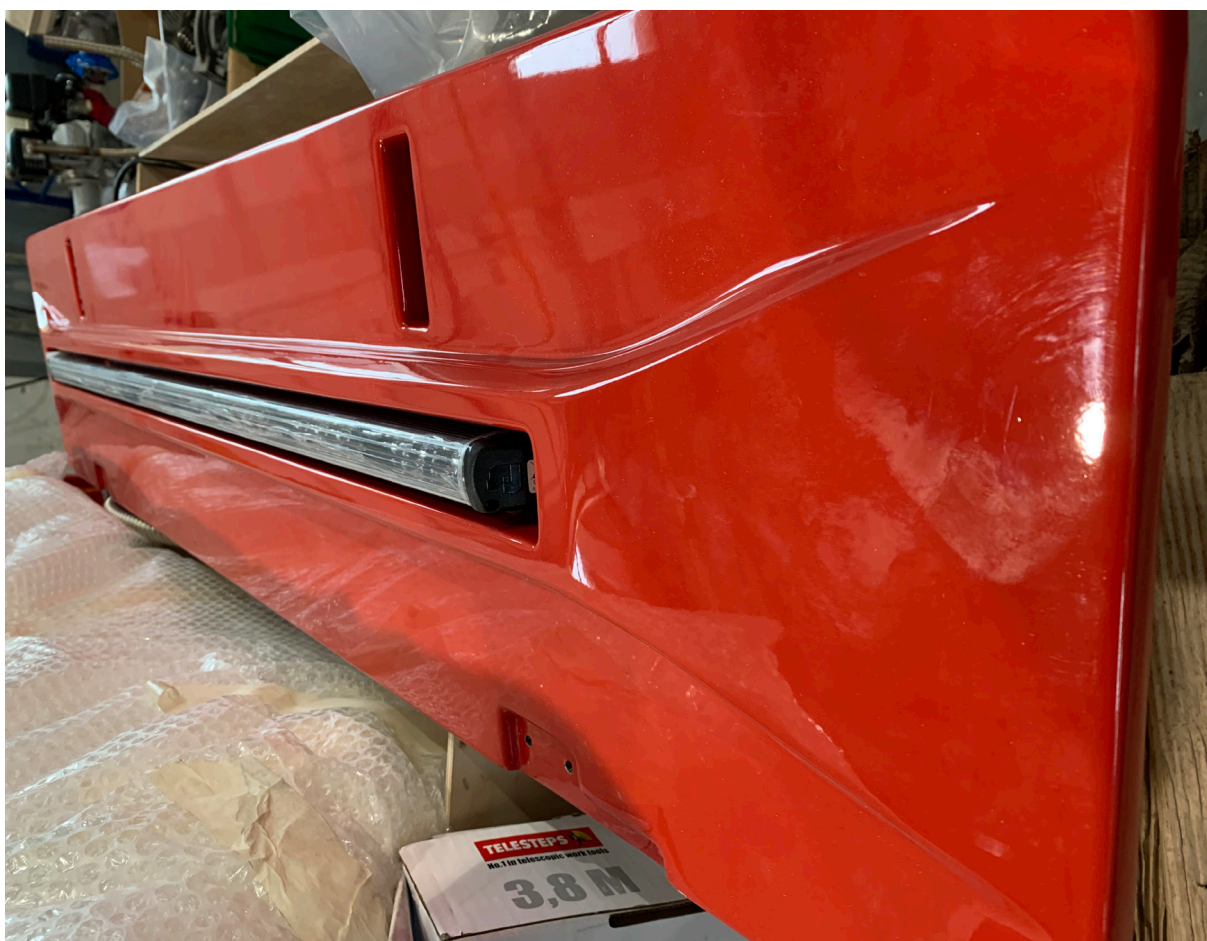
Nr 93. Widok burty z zamontowaną falą świetlną FM Bumar S.A / w Koszalinie
