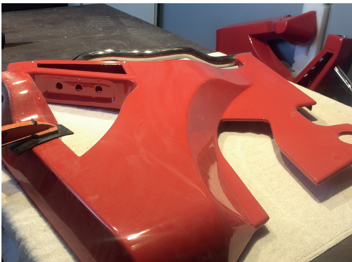
Nr 74. i Nr 75. Poszczególne elementy fotela wykonane w technice laminatu dla FM Bumar S.A / w Koszalinie
