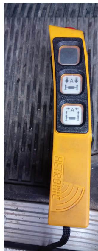
Nr 30 A. Projekt opisu funkcji pilota sterowania radiowego do rozstawiania podpór w podnośniku pożarniczym / FM Bumar S.A / w Koszalinie
