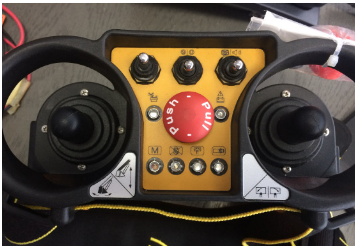
Nr 30. Projekt opisu funkcji pilota sterowania radiowego do rozstawiania podpór w podnośniku pożarniczym / FM Bumar S.A / w Koszalinie
