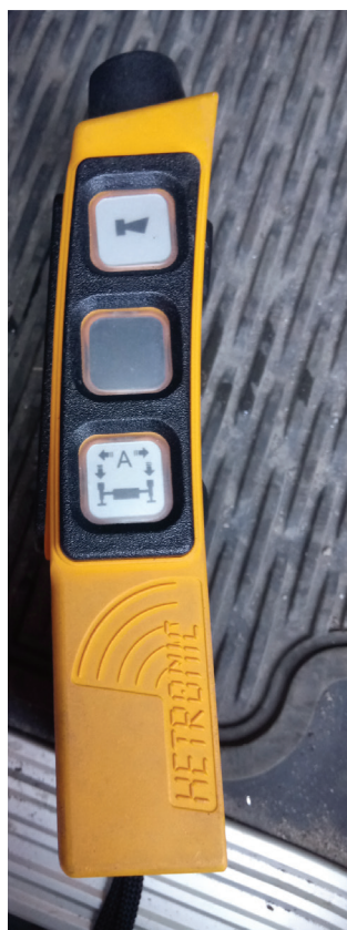
Nr 30 A. Projekt opisu funkcji pilota sterowania radiowego do rozstawiania podpór w podnośniku pożarniczym / FM Bumar S.A / w Koszalinie
